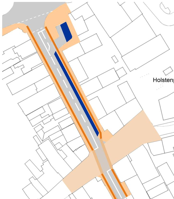
Im Rahmen einer Umgestaltung der Holstenstraße sollte auch der Kreuzungsbereich Holstenstraße/Königstraße durch einen Belagwechsel (Aufpflasterung) umgebaut werden, so dass die Achse zwischen Fußgängerzone und Bahnhof auch gestalterisch hervorgehoben wird. Gleichzeitig ist eine solche Maßnahme auch im Hinblick auf die angestrebte verkehrliche Entlastung und Beruhigung der Holstenstraße vorteilhaft, da das Geschwindigkeitsniveau merkbar gesenkt werden kann.
